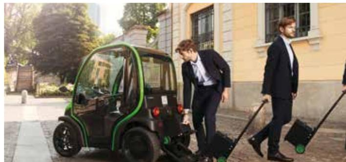
Das herausnehmbare Batteriesystem **Lithium Re-Move** ermöglicht einen schnellen, werkzeuglosen Ausbau des Akku-Packs. Nehmen Sie den Rollkoffer-Akku des Birò mit nach Hause, ins Büro oder wohin Sie wollen, um ihn an einer normalen 230 V Steckdose aufzuladen. Reichweite bis zu 55 Kilometer<sup>2</sup>, Ladezeit ca. 2 – 4 Stunden (teilweise Ladung möglich).
